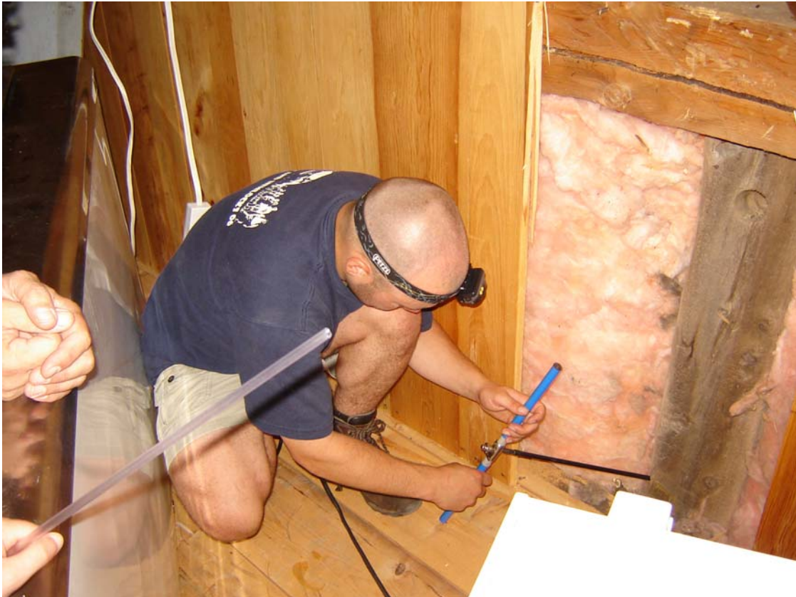
Figure 2 : Des panneaux ont dû être enlevés afin de permettre l'accès aux poutres de la maison Dugas. Un chercheur s'affaire à extraire une carotte de 4.3 mm de diamètre à l'aide d'une tarière.
